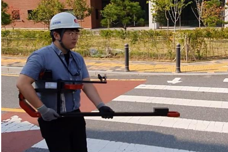
<그림1-1/2-1> 레이저 스캐너와 이미지 획득을 통한 3D 공간정보 획득
