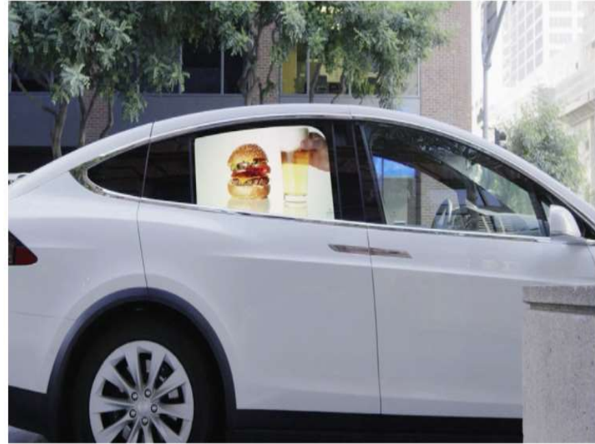
탑승자 엔터테인먼트/야외 광고 효과를 도입한 차량용 측면 윈도우 투명 디스플레이 기술 확보
